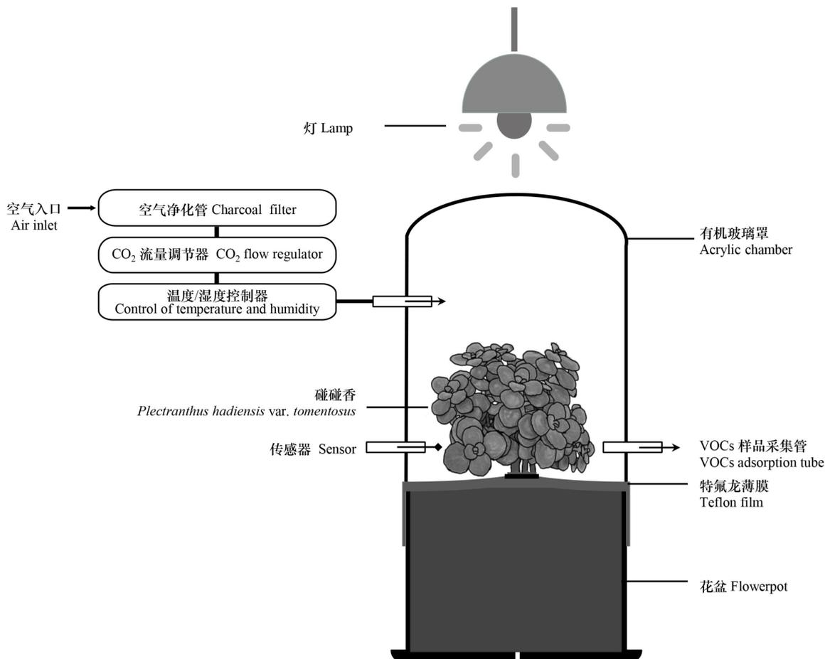
图 1 用于测量碰碰香 VOCs 释放的装置
